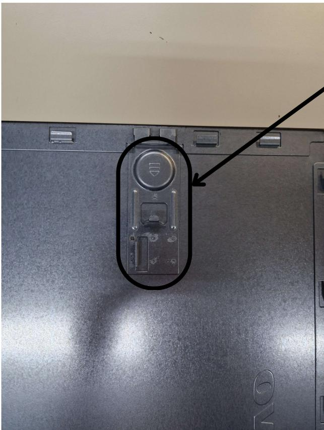
Vous pouvez constater sur la photo un système de verrouillage vu de l'intérieur du boîtier. Il suffit d'appuyer sur l'endroit où il y a une flèche et de pousser suffisamment fort pour faire sortir le panneau.
